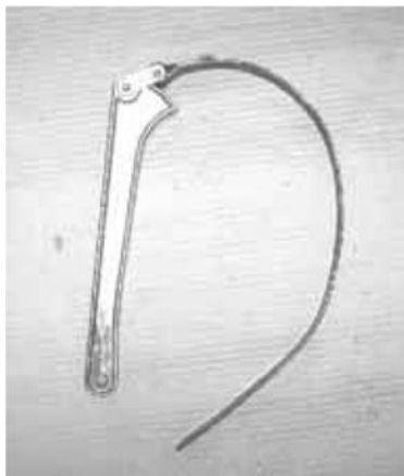
图 2.6 - 典型带式扳手(未提供), 用于拧紧 CPVC 管接头
